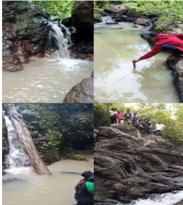
Gambar 3. Pengukuran Debit, Kecepatan dan Tinggi Head Air Terjun
