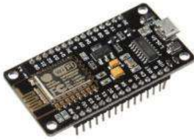
Gambar 2. Node MCU ESP8266
