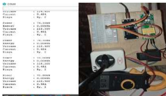
Gambar 8. Percobaan pengukuran digital clamp meter dan sensor PZEM-004T
