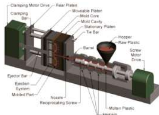
Gambar 1. Komponen Mesin Injection Molding
