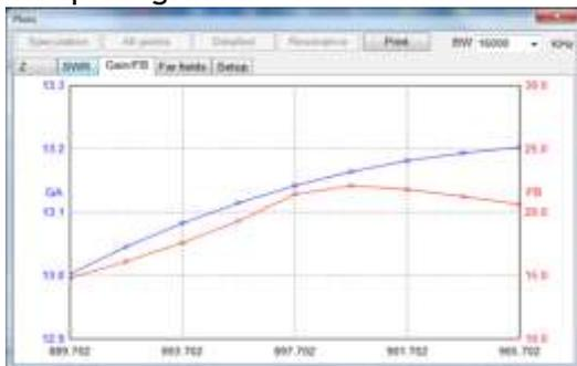
Gambar 11. Plot Nilai Gain/FB pada simulasi MMANA
