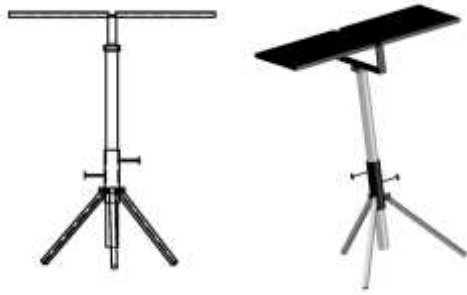
Gambar 1. Perancangan alat portable solar panel
