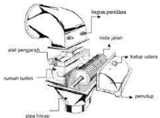
Gambar 2. Konstruksi Turbin Osberger atau Turbin *Cross-flow*
