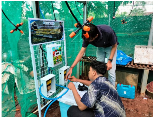
Gambar 5. Implementasi Sistem Nutrisi Otomatis Berbasis IoT untuk Meningkatkan Produktivitas Pembenuhan Hortikultura di Screen House
