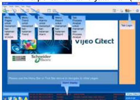
Gambar 41. Tampilan pertama HMI SCADA
