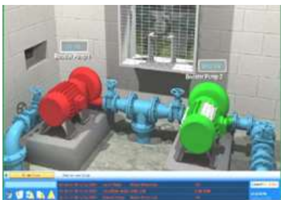
Gambar 8. SCADA Vijeo Citect
