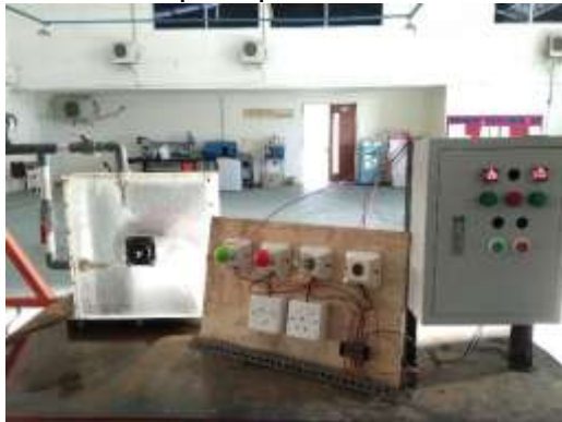
Gambar 9 pengujian PLTA PH dengan beban Nol
