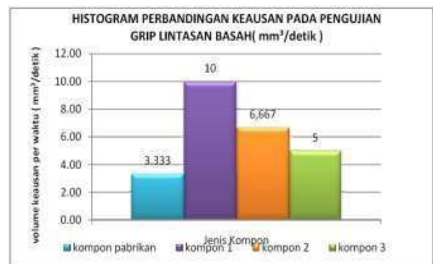
Gambar 4. Perbandingan keausan pada pengujian lintasan basah
