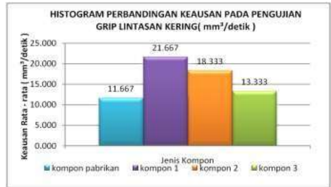
Gambar 3. Perbandingan keausan pada pengujian lintasan kering
